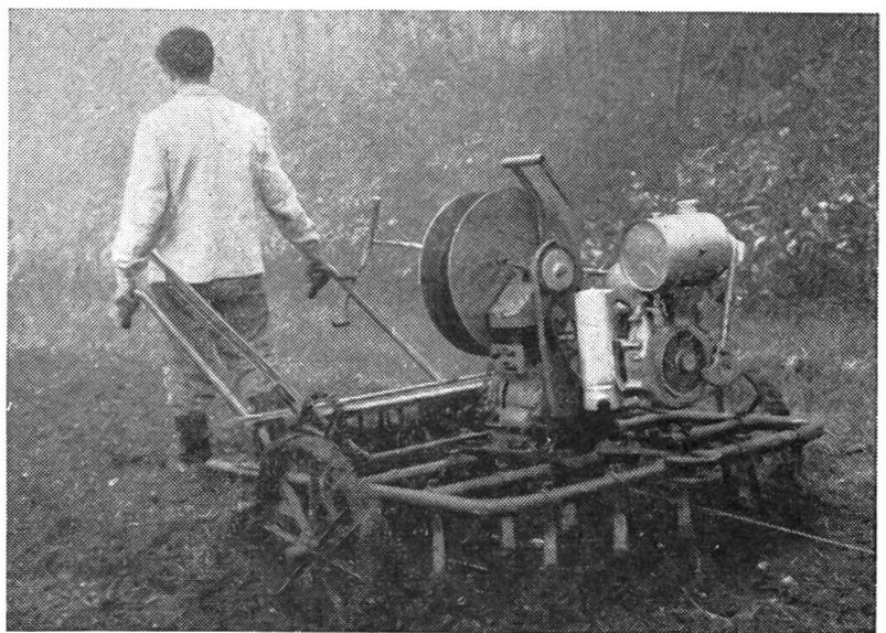
Abb. 8: Die Egge mit aufgebauter Selbstaufzugwinde
