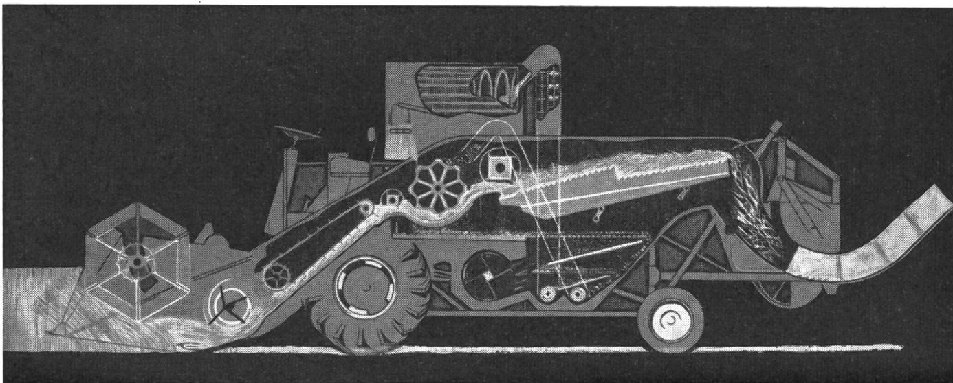
Abb. 3: Die Arbeitsweise eines Mähdruschers
