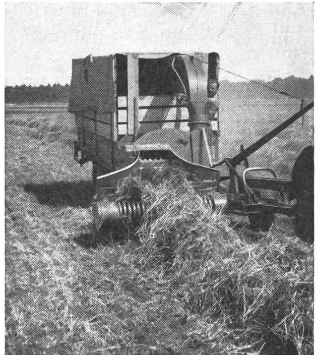
gezeigt, dass Traktoren zwischen 25 und 30 PS nur unter günstigen Bedingungen, d. h. zum Ernten von lagerfähigem Heu oder Mähdrescherstroh ausreichend sind. Unter normalen Verhältnissen, ohne starke Hanglage und für Grünfutter, sind Zugmaschinen mit 30 bis 35 PS erforderlich. Bei ungünstigen Arbeitsbedingungen benötigt man sogar einen Traktor von mindestens 40 PS.
