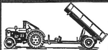
Zapfwellenkipper mit oder ohne Auflaufbremsen
