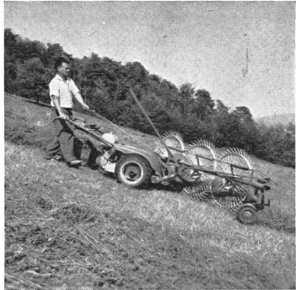
Abb. 3a und 3b: Front-Ketten- und Sternradrechen bei 40 bis 45 % Steigung. Mit den Sternradrechen muss bei diesem Gefälle in der Falllinie gefahren werden.
