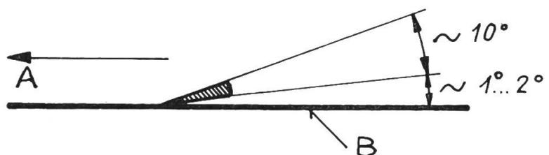
soll nur die Schneide die Furchenwand berühren und die linke Messerfläche mit der Furchenwand einen Freiwinkel von ca.  $1-2^\circ$  bilden. In der vertikalen Ebene beträgt der Winkel  $X$  in unseren Verhältnissen ca.  $65^\circ$ . Er soll soviel betragen, damit die Pflanzenwurzeln, Steine usw. an der Schneide entlang nach oben gleiten können. (Bei Annahme eines Reibungswinkel von  $25^\circ$  beträgt  $X = 90^\circ - 25^\circ = 65^\circ$ .)
