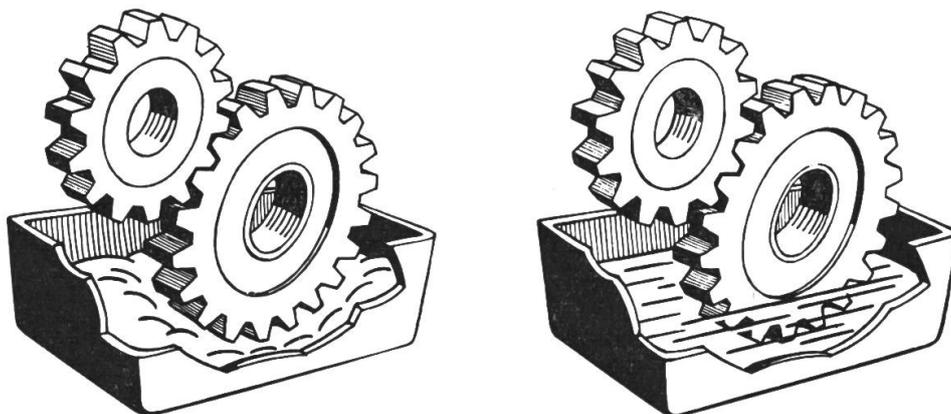
Abb. 6: Links: Ein für die Getriebeschmierung ungeeigneter, zu dicker Schmierstoff (Grabenbildung)
