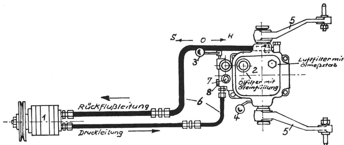
Abb. 14: Hydraulische Hebevorrichtung für Dreipunkt-Aufhängung mit geschlossenem Oelkreislauf
