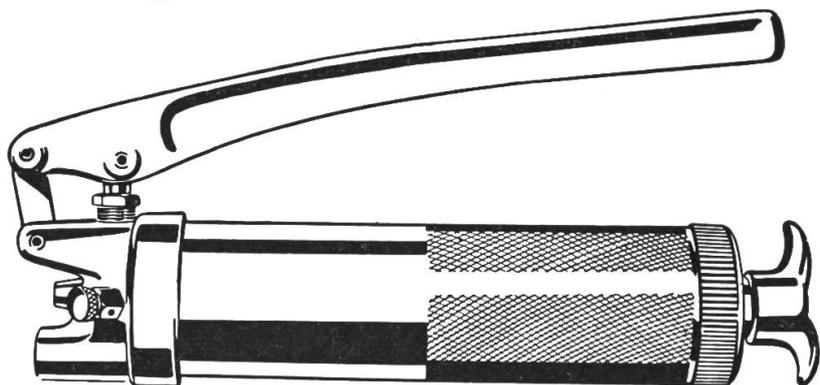
**Die Hochdruck-Fettpistole.** Sie ist im wesentlichen eine verkleinerte Handhebelpresse. Ihre äussern Masse gestatten es aber nicht, sie in einem Werkzeugkasten von der üblichen Grösse unterzubringen. Der Schmierdruck beträgt ca. 400 atü, je nachdem, ob die Pistole ein- oder zweihändig bedient wird. Nachteilig für ihre Verbreitung ist, wie schon erwähnt, der hohe Ankaufspreis (ca. Fr. 40.—).
