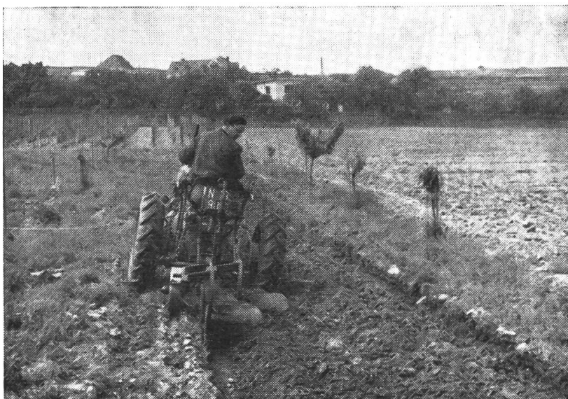
Abb. 5 Derselbe Schmalspurtraktor mit umgesteckten Rädern und einem normalen Pflug bei der Arbeit
