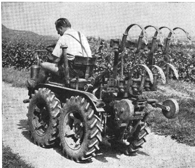
Abb. 3 Die Geräte sollen senkrecht ausgehoben werden können.
