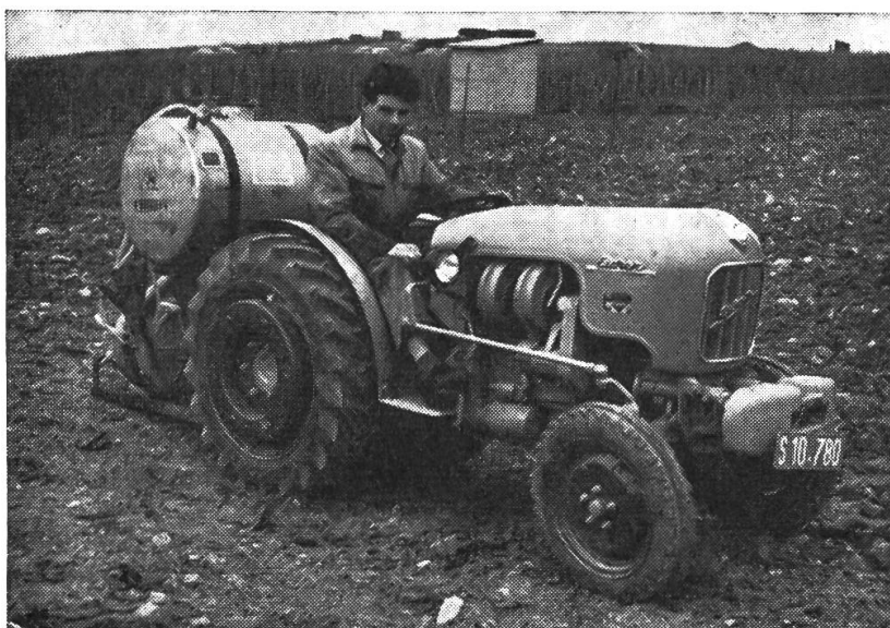
Abb. 7 Ein Weinbauspezialtraktor mit einer Motorleistung von 28 PS und Hinterradantrieb. (Aufbaugerät: Gebläsesprüher für Wein- und Obstbau)
