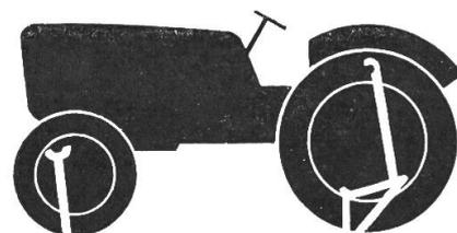
Sich selbst aufbocken können A 3 K und A 3 KT mit einem einfachen Zusatzgerät. Das ist eine grosse Erleichterung zur Spurverstellung und dient auch zur Reifenschonung während längerer Ruhepausen.
