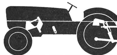
Deshalb passen alle Arten von Geräten zum Güldner-3-Zylinder! **Das Mähwerk kann beim A 3 KT zusammen mit Zwischenachsgeräten und Frontlader immer angebaut sein.** Ackerschneibe und Dreipunktaufhängung mit kräftiger Hydraulik hat der A 3 K, der A 3 KT hat ausserdem noch Zwischenachsenanbau, ebenfalls mit Hydraulik, die getrennt und gleichzeitig zu steuern geht.
