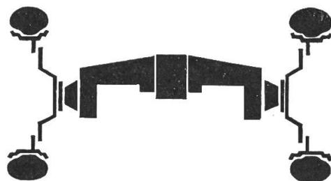
Für Hack- und Pflegearbeiten kann die Spurweite von 1250 mm auf 1500 mm verstellt werden.
