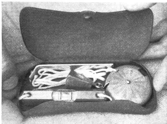
Abb. 2: Zusammengefaltet nimmt der neue Steigungsmesser nur wenig Platz ein; bequem lässt er sich in der Westentasche mitnehmen.
