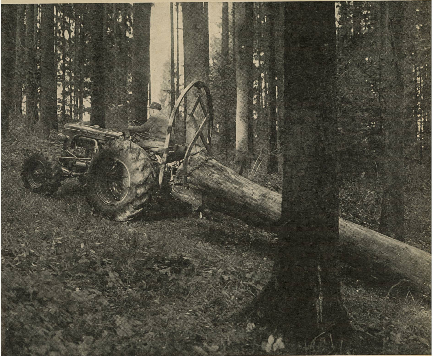
Der neue HÜRLIMANN D-100 Super-Spezial Allrad-Antrieb beim Schleppen einer grossen Tanne, bei einer Steigung von 34 %.
