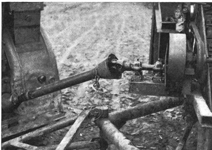
Abb. 3: Kreuzgelenk und Maschinenwelle ohne Schutz am Rübenblatterter.
