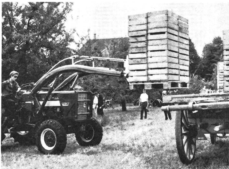
Abb. 5: Frontlader beim Harassen-aufladen. Das Parallelführungsgestänge erlaubt die senkrechte Haltung des Stapels.
