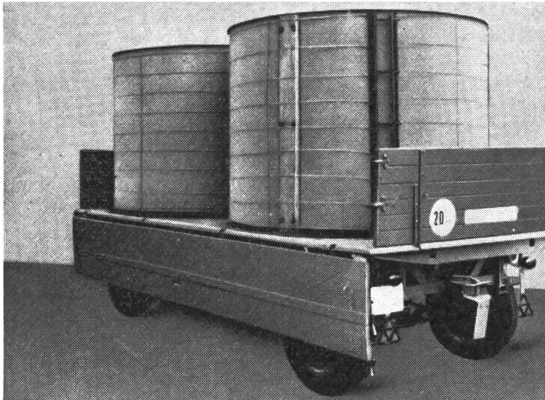
Abb. 4: Runde Korntransport- behälter aus Hartfaser- platten auf normalen Ackerwagen.
