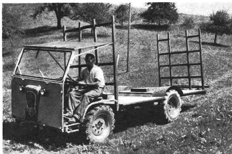
sind in der Zugleistung auf das Gewicht bezogen am besten. Sie können in speziellen Fällen befriedigen. Der Allradantrieb kann nur voll zur Auswirkung kommen, wenn die Nutzlast auf das Fahrzeug geladen wird (Abb. 5). Das Fahrzeug kann im Gewicht leichter gebaut werden. Es kann, wenn es für den Zug gebraucht wird, noch mit Nutzlast belastet werden.
