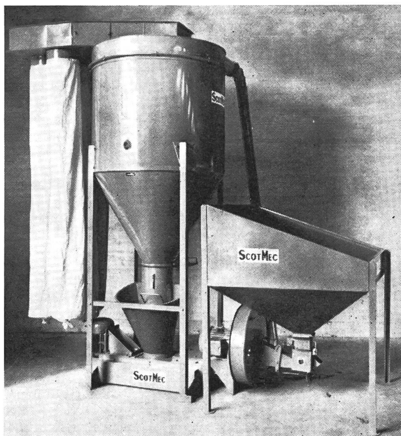
Abb. 1: ScotMec-Mahlmischer komb. mit Hammermühle und Mischer. Getreide- zufluss durch Schwer- kraft, genau reguliert mit Ampèremeter. Anlage kann automatisch geliefert werden. (Werkbilder Fa. Ges. für Oberflächentechnik)
