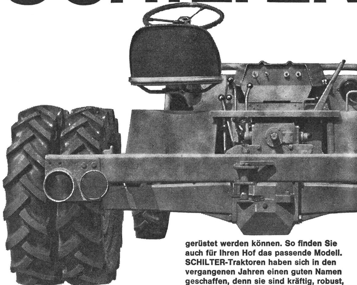
Nur Schilter hat ein ganzes Programm von solchen Traktoren: 1000, 1500 und 2000 kg Nutzlast. 3 Typen, welche je nach Bedarf mit Benzin- oder Dieselmotoren in den Leistungsbereichen von 9 PS bis 22 PS aus-
