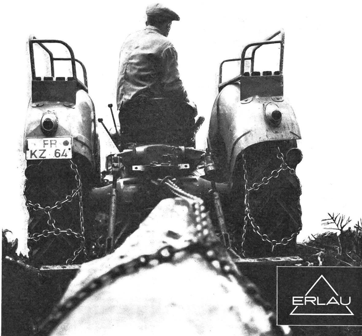
Wenn's glatt, schmierig oder matschig wird, bringt nur gute Griffigkeit die Motorleistung voll auf den Boden: **ERLAU-EUROPA-Traktorenketten!** Ihre Griffelemente sind einmalig. Massive Edelstahl-Stege. Wie kräftige Krallen greifen sie tief in den Grund. Exakte Spurhaltung, hohe Anfahr- und Bremsfestigkeit, rasche Selbstreinigung sind die Resultate.
