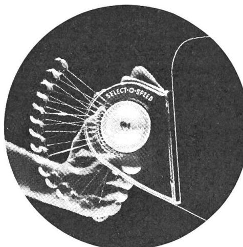
beim Schalten. Mit der Hand den Schalthebel fassen und in den nächsten Gang schieben. Das ist alles. Das Getriebe ist immer im Eingriff, sogar im Moment des Schaltens. Einen Freilauf gibt es nicht. Das Select-O-Speed-Getriebe wirkt gleichzeitig als Motorbremse. Eine Handbremse ist also überflüssig. Ideal im coupierten Gelände der Schweiz. Über 40 000 Ford-Traktoren mit Select-O-Speed sind schon im Einsatz!
