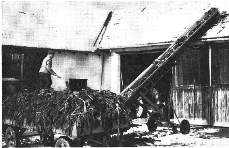
Abb. 5: Förderband beim Fördern von Rübenblatt
