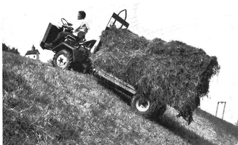
Abb. 4: Der Transporter im Seilaufzugverfahren bei 85 % Steigung.
