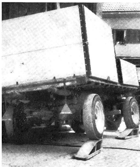
anheben auf einfachste Weise mit Keil oder Hebewinde
