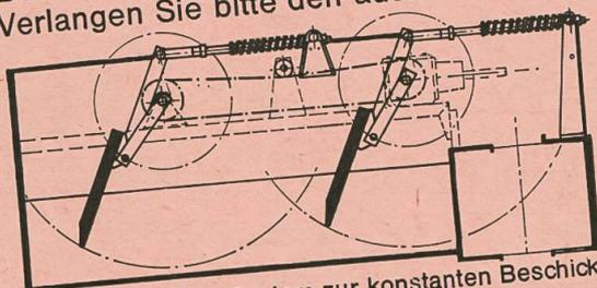
Patentiertes AMA-System zur konstanten Beschickung des Presskanals.
