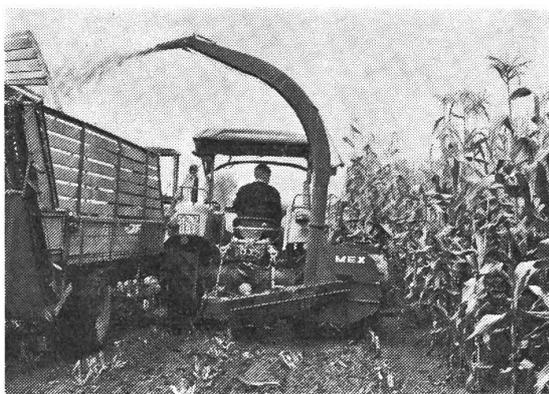
1. Erzielung eines exakten Querschnittes von 5 mm, der das Aufschliessen jedes einzelnen Maiskornes garantiert. Das bewährte Scheibenradprinzip in Verbindung mit exakter Vorpressung direkt am Schneidmund
