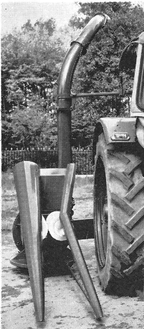
Diese Maschine arbeitet weder mit Einzugsketten, noch hat sie eine Messertrommel. Als Schneidwerkzeug dient eine Schneidscheibe, ähnlich wie beim Rübenschneider. Durch die Blattheber werden die Maisstengel dem Schneckeneinzug zugeführt, wobei sie durch Mähmesser am Aussenrand der Schneidscheibe gemäht und dann, aufrecht stehend, von oben nach unten durch die Schneidscheibe gestossen und von den Häckselmessern geschnitten werden. Die Häcksellänge ist stufenlos von 7 bis 18 mm einstellbar.
