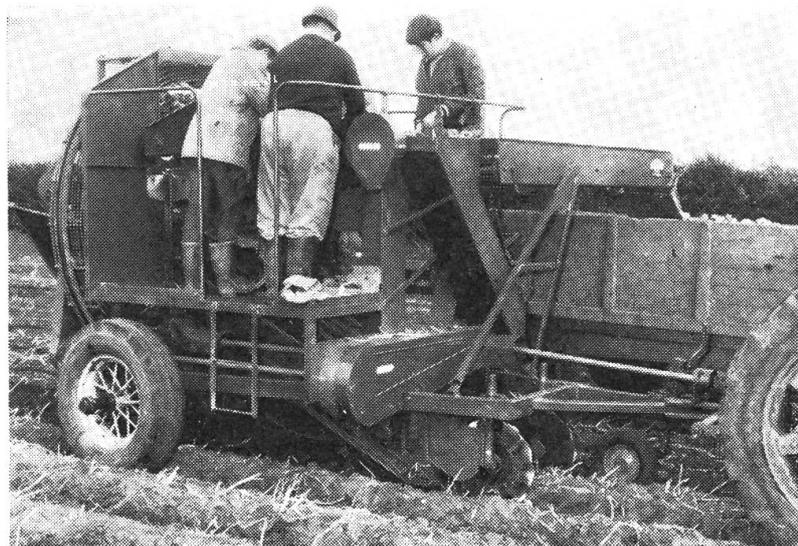
Bei F. P. Standen & Sons, Ely, wurde die selbstfahrende Rübenerntemaschine viel beachtet. Die einreihig arbeitende Maschine kann von einem Mann allein bedient werden. Ein Ueberladebunker sammelt die Rüben. Motorausrüstung verschiedener Fabrikate nach Wahl. Der Tank hat ein Fassungsvermögen von 1,5 l.
