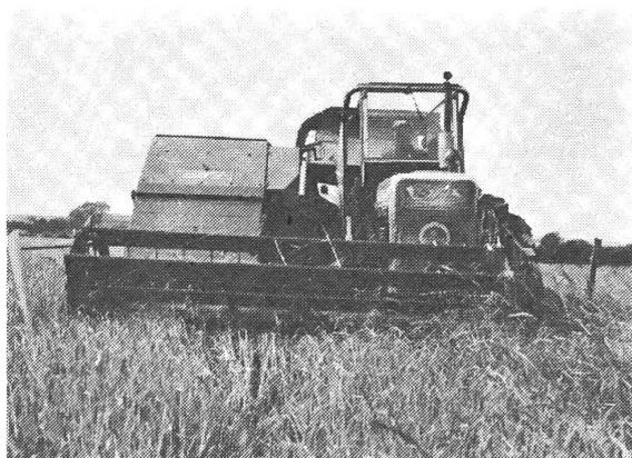
Zum JF-Mähdrescherprogramm ist zu sagen, dass diese heute in zwei Ausführungen lieferbar sind, und zwar Typ MS 70 mit 1,5 bzw. 1,8 m Schnittbreite und Typ MS 90 mit 2,4 m Schnittbreite. Der Kraftbedarf ist 25 respektive 35 PS. Die Leistung der beiden Maschinen wird mit 12–18 Dz/Std. bzw. 25–35 Dz/Std. angegeben, je nach Traktor und Getreideart. Das Interessanteste an den JF-Mähdreschern ist jedoch zweifellos der Preis.
