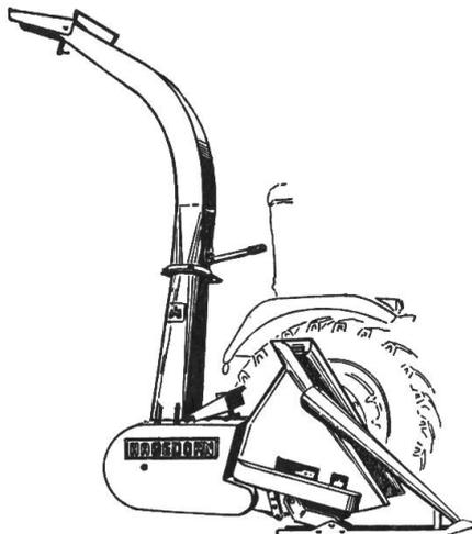
Im Eiltempo verwandelt der HAGEDORN-Maishäcksler HM 69 einen ausgewachsenen Maiswald in nahrhaftes Kraftfutter. Sauber gekappt, exakt auf 6 mm Schnittlänge gehäckselt, präzise auf den angehängten Wagen geblasen. In zügigem, störungs- und verstopfungsfreiem Fluss verarbeitet die Maschine Stengel, Blätter, Kolben. Nichts geht verloren.
