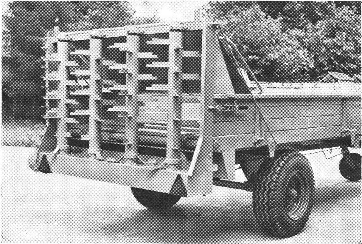
Das neue 4-Walzen-Streuwerk ist ein AGRAR-Fabrikat. Mühelos und ohne Werkzeug ist es von der Maschine abnehmbar. Die 4 Ölbad-Getriebe und einsetzgehärtete Zinken vermindern die Abnutzung stark.
