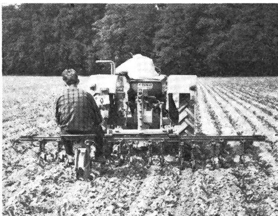
12-reihige Hackmaschine, Arbeitsbreite 6,00 m im Einsatz
