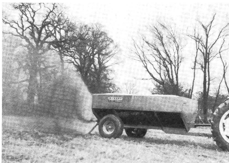
Abb. 2: «Howard» Schleuderwagen für Kot aus Laufställen.
