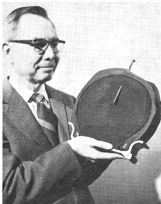
Querschnittaufnahme vom Goodyear-Schaumstoffreifen.
