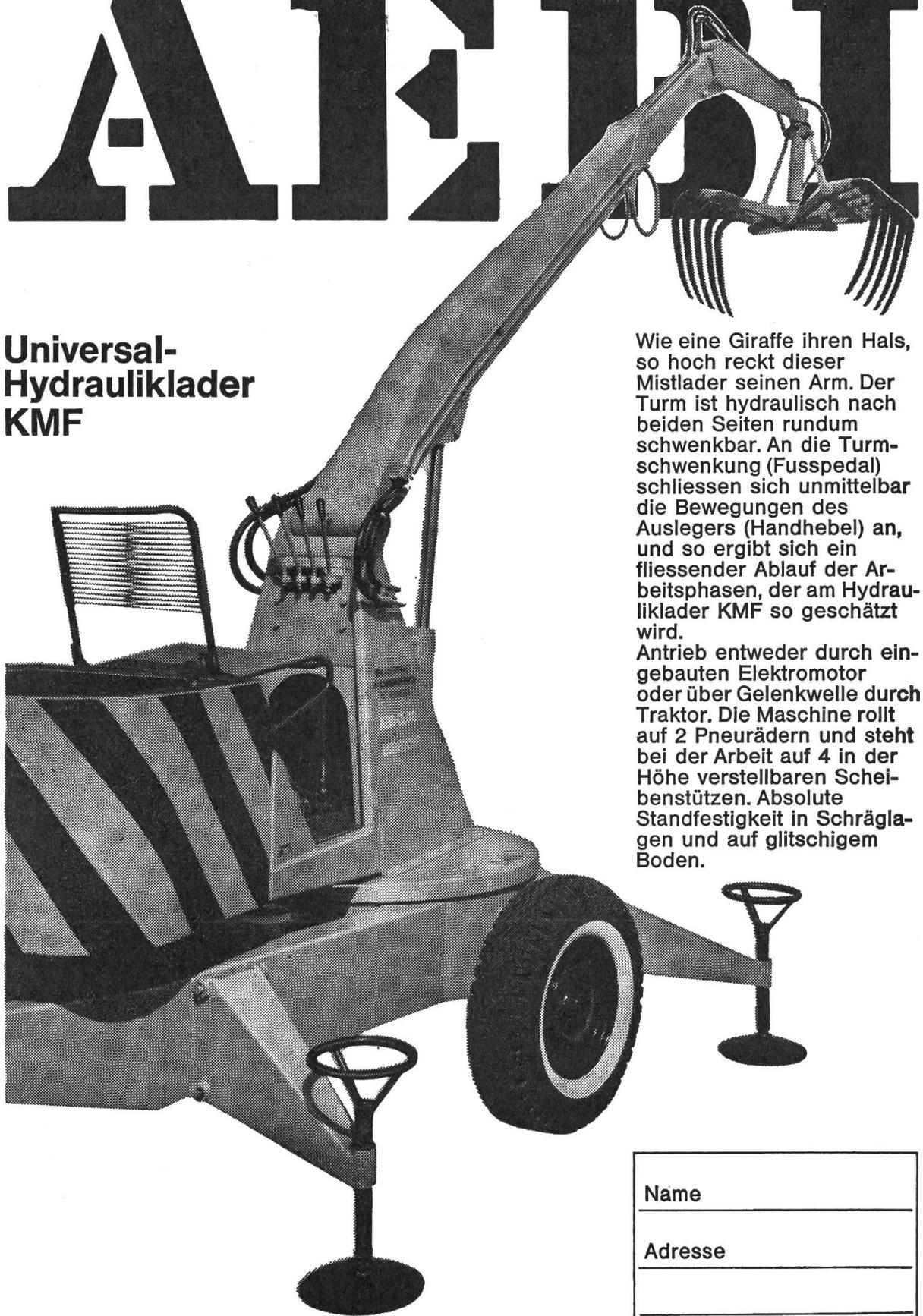
Wie eine Giraffe ihren Hals, so hoch reckt dieser Mistlader seinen Arm. Der Turm ist hydraulisch nach beiden Seiten rundum schwenkbar. An die Turmschwenkung (Fusspedal) schliessen sich unmittelbar die Bewegungen des Auslegers (Handhebel) an, und so ergibt sich ein fließender Ablauf der Arbeitsphasen, der am Hydrauliklader KMF so geschätzt wird.
