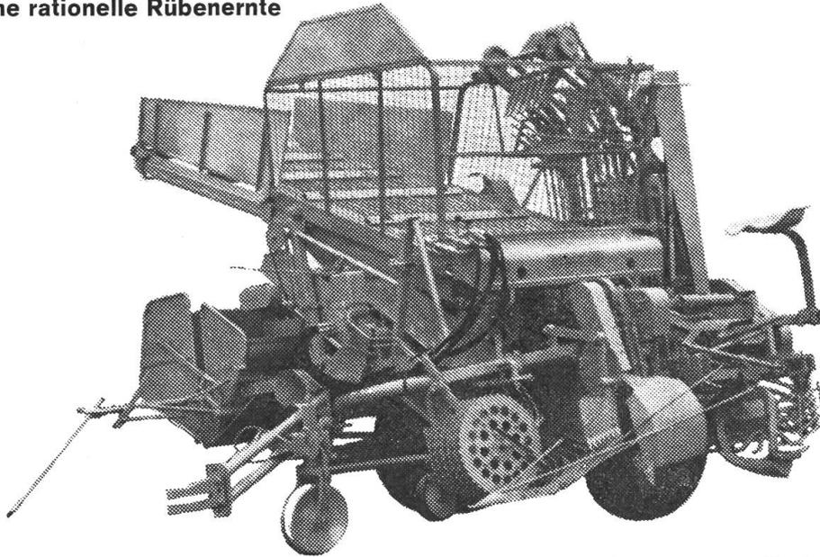
schneidet die Blätter, rodet, putzt und erntet eine Reihe in einem Arbeitsgang. – Vollhydraulisch. – Rübenbunker. – Einwandfreie und rascheste Ernte, auch bei schwierigen Bodenverhältnissen. – Ein-Mann-Bedienung. Verlangen Sie bitte Prospekte und Preisliste.
