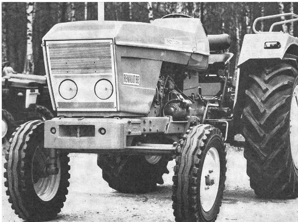
Preis und Qualität und Leistung sprechen für RENAULT 88. Zum Beispiel 55 PS **vollsynchronisiertes** 12-Gang-Getriebe, Unterlenker-Regelhydraulik, Doppelkupplung, Gesundheitssitz, Blinklichtanlage, Scheibenbremsen.
