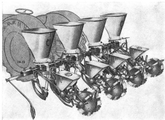
Mit dem «Muli 330» lassen sich mehrere Arbeitsgänge zusammenfassen: Saatbeetbereiten, Unterfussdüngung, Einzelkornablage, Band- oder Flächenspritzung.
