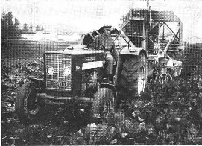
Abb. 4: Auch bei der Zuckerrübenenernte bringen die Breitreihen (50 cm) Vorteile; Blattverluste und -verschmutzungen sind geringer als in schmalen Reihen.
