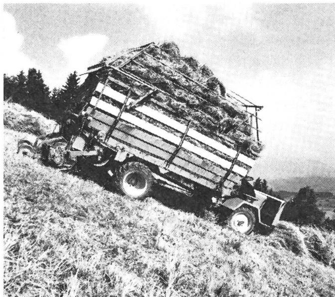
Der Mehrzwecktransporter mit einem ausgereiften Ladegerät erzielt im Hanggelände recht hohe Leistungen.
