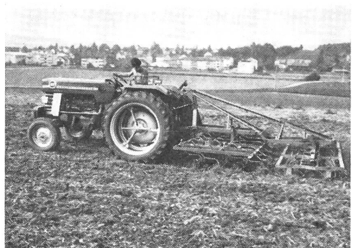
Abb. 3b: Die erforderliche Saatbettqualität lässt sich meistens nach einem zusätzlichen Durchgang mit einem Vibrierzinkenkultivator erreichen.
