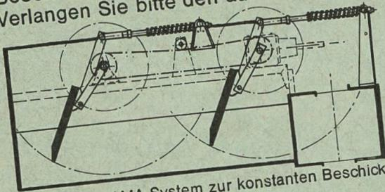
Patentiertes AMA-System zur konstanten Beschickung des Presskanals.
