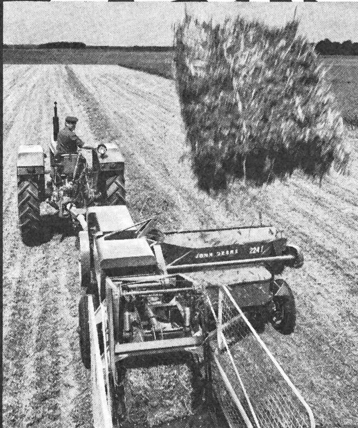
Grosse Ballen, kleine Ballen. Mit der John Deere Hochdruckpresse 224 ist das kein Problem mehr. Sie können bei dieser Presse die Grösse der Ballen stufenlos einstellen. Von 0,30 bis 1,27 m.
