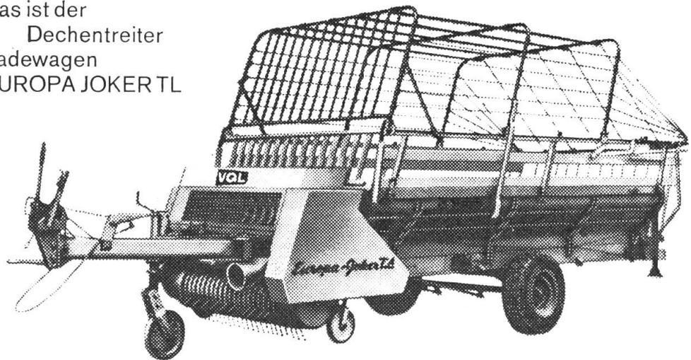
Mit JD-Schnellaufnahme-Vorrichtung und dreifach höhenverstellbarem Vario-Dürrfutteraufbau, abklappbarem Schneidewerk bis 9 Messer.
