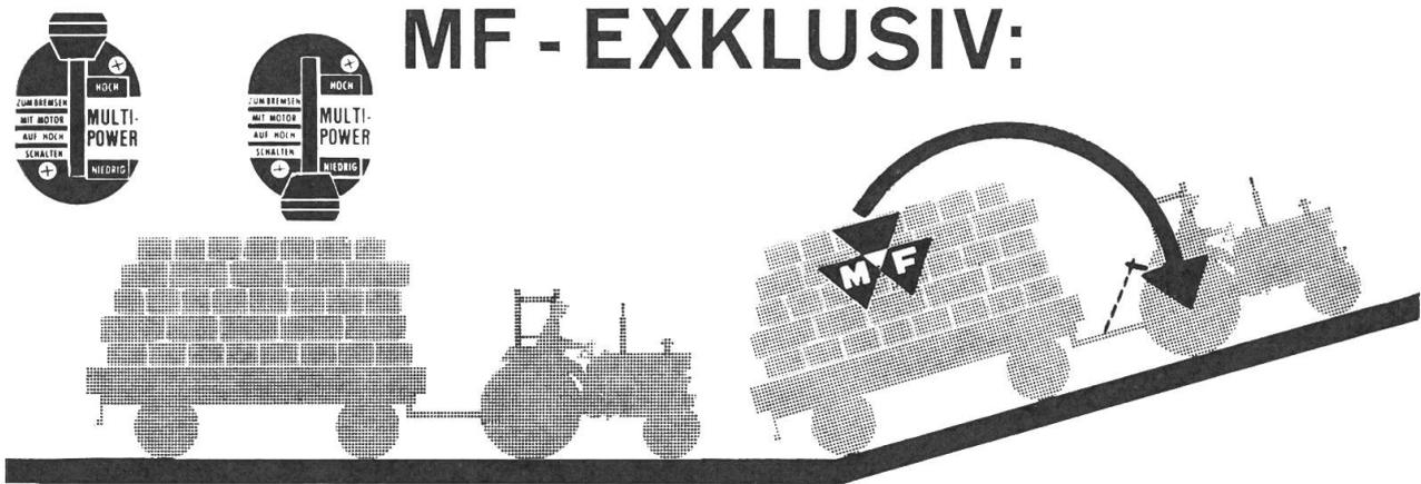
**Multi-Pover:** Das Getriebe ohne Lücken, robust und störungsfrei. Mit dem Zugkraftverstärker um 30 % erhöhte Zugkraft.
