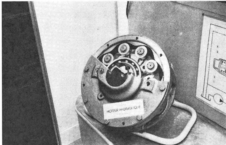
Abb. 3: Schnittmodell «Hydraulik- motor»
