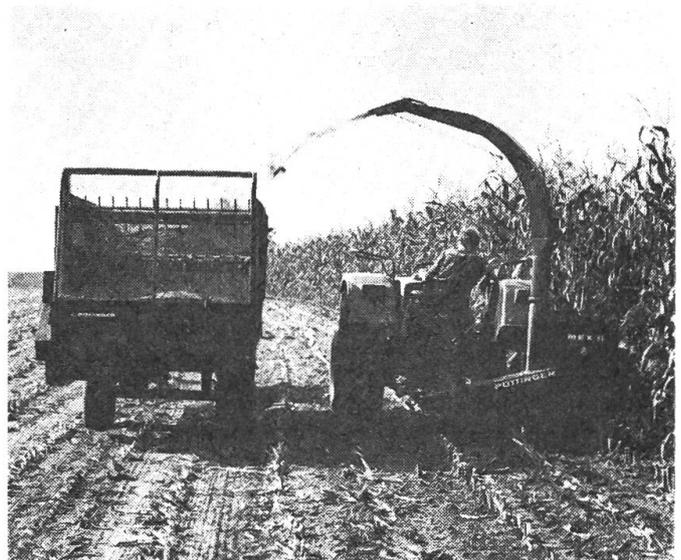
Abb. 3: Neuzzeitliche Maiserntekette: am Traktor angebaute Maishäcksler und einachsiger Häckselwagen mit seitlicher Austragvorrichtung zum Beschicken von Gebläsen, Förderbändern oder Krippen.
