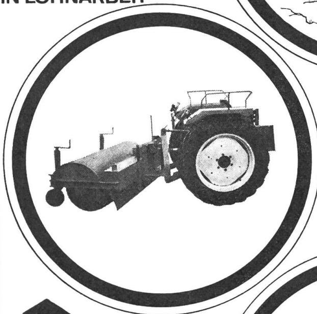
Wira und Kobre Kehrmaschinen mit Wassersprühvorrichtung, Sammelbehälter oder zum Seitwärtskehren leisten eine saubere Arbeit. Einfacher Anbau an jedem Traktor.
