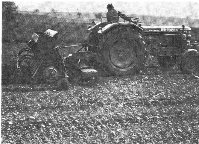
Abb. 2: Bestellsaat (z. B. für Getreide) mit Kreisel-egge und Sämaschine.
