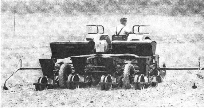
Die neue Erntemaschine wird an das Dreipunktgestänge des Traktors angebaut. Das eigentliche Ernteaggregat besteht aus einem Rahmen mit zwei rohrförmigen Rüttelzylindern. Die übrigen Einzelheiten können teilweise der Abbildung entnommen werden. Da es sich um einen Prototyp handelt ist noch nicht jedes Detail bekannt. Hersteller: Smallford Planters Ltd, Hatfield Road, St. Albans, Hertfordshire (England).
