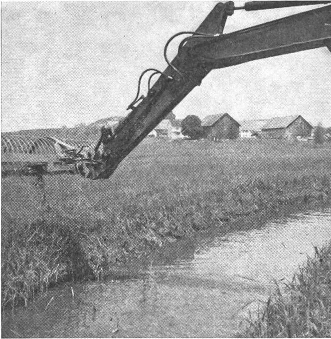
Mähkorb, angebaut am hydraulischen Bagger, beim Mähen und Räumen eines Entwässerungsgrabens.
