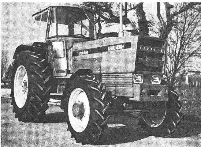
Auch dieser neue Typ verfügt über das bekannte vollsynchronisierte Getriebe, die Unterlenker-Regelhydraulik, die lastschaltbare Motorzapfwelle mit 2 Geschwindigkeiten, den vibrationsfreien Fahrerstand, die Warmluftgebläseheizung und vieles andere mehr. «GLOBE»
