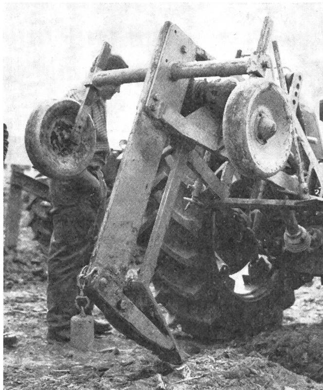
Abb. 1: Untergrundlockerer mit Wippschar. Er kann den Boden bis 90 cm tief lockern.
