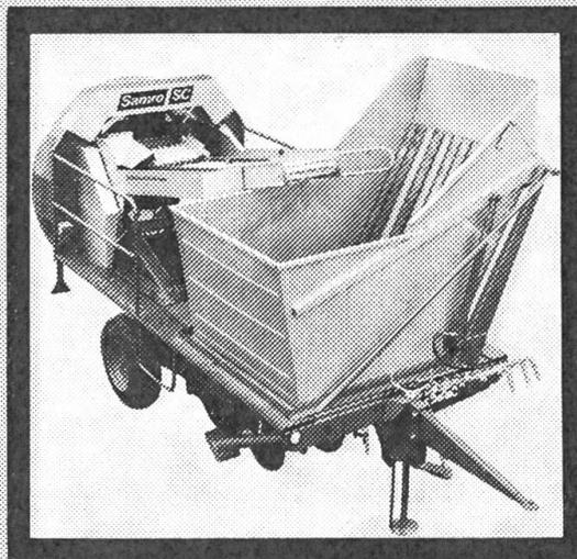
**2 Perfekte Dammaufnahme.** Gefederte Scheibenseche, keine angeschnittenen oder nicht ausgehobenen Kartoffeln. Randfurchen können durch die besondere Anordnung der Dammaufnahme ohne Befahren des Nachbarfeldes geerntet werden.
